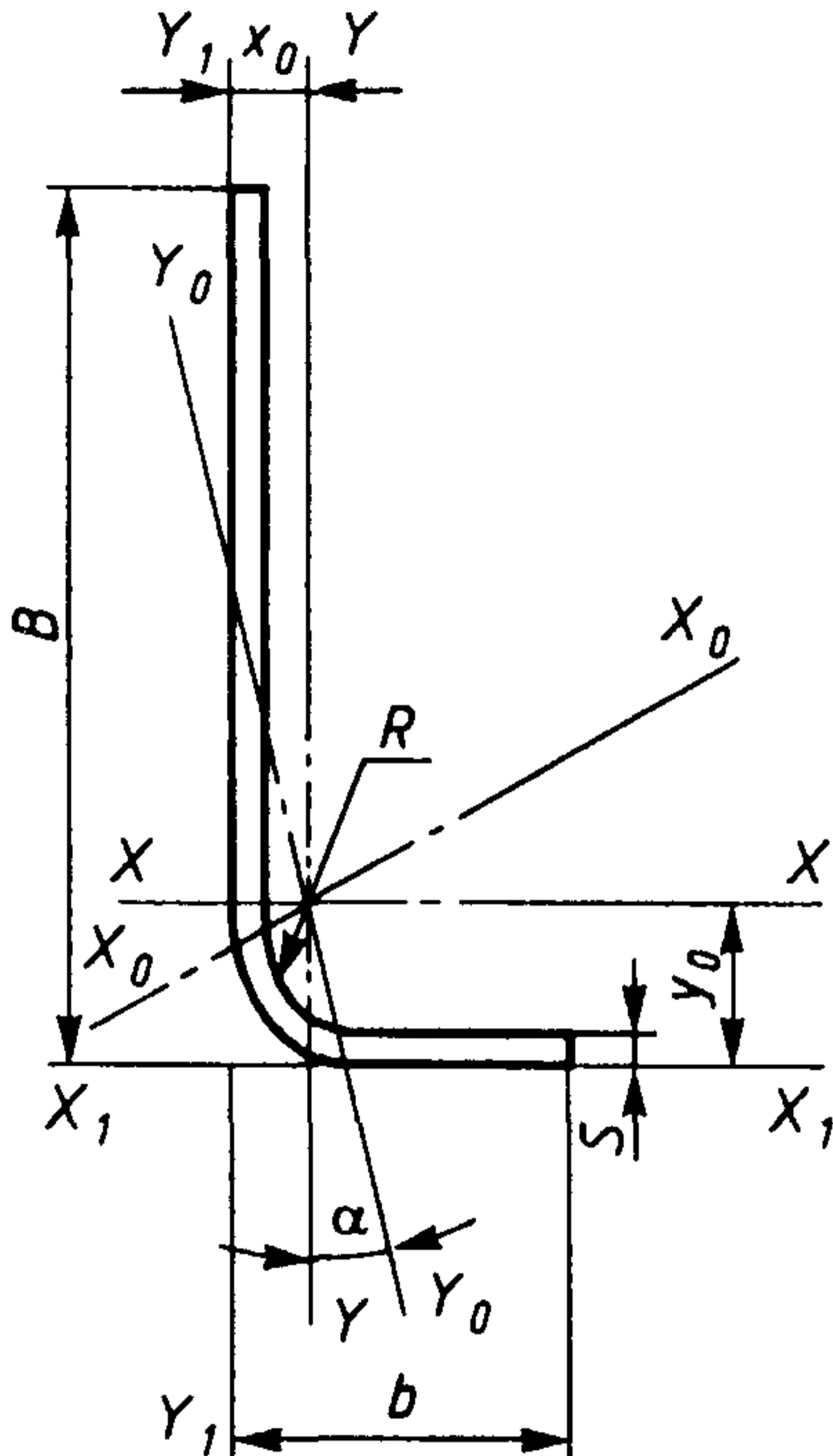
$n^1 = \frac{B - S - R}{S}$  — отношение расчетного свеса большей полки к толщине профиля;
